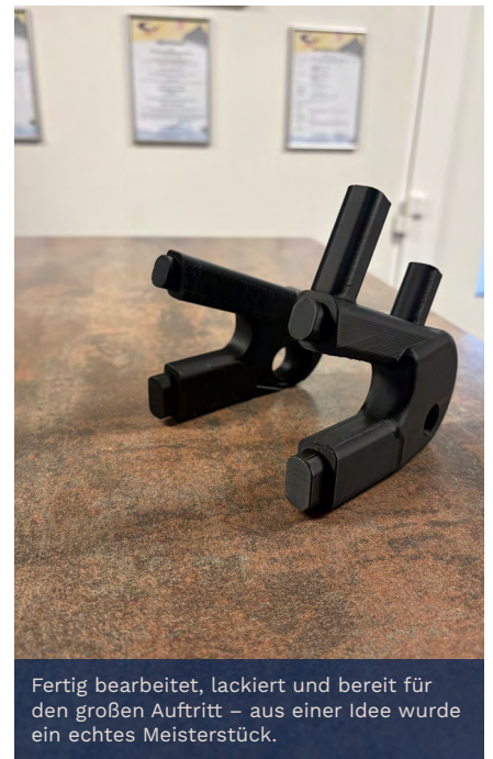
Aus einem massiven Aluminiumblock entstand Stück für Stück das Herzstück des Meisterprojekts.
